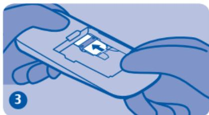
Achten Sie darauf, dass die SIM-Karte durch den Plastikbügel festgehalten wird.
