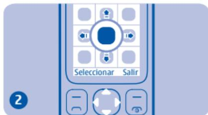
2 Para dirigirse a una función, pulse la tecla de desplazamiento hacia arriba, abajo, izquierda o derecha.
