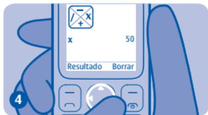
Para cambiar una función, utilice la tecla de desplazamiento.
