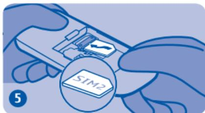
Deslice la SIM2 por debajo de la pieza metálica.
