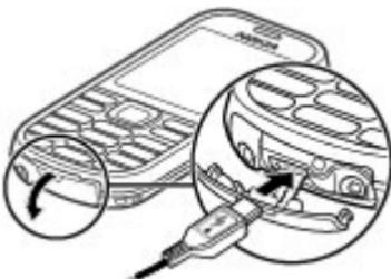
Otvorite poklopac USB priključka i spojite USB kabel u uređaj.
