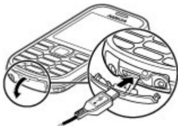
Otvorite poklopac USB konektora i povežite USB kabl sa uređajem.
