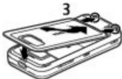
3 Pour remettre le cache en place, orientez d'abord les cliquets de verrouillage inférieurs vers leurs fentes, puis appuyez jusqu'à ce que le cache se verrouille.
