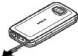
Certaines fonctions, notamment la reconnaissance de l'écriture, sont conçues pour être utilisées avec un stylet. Le stylet est situé dans le capot arrière de l'appareil.
