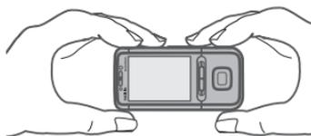
Per la messa a fuoco automatica, premere il tasto della fotocamera a metà. Sul display appare una cornice bianca. Al termine della messa a fuoco, il colore della cornice diventa verde ed è possibile scattare la foto premendo completamente il tasto della fotocamera. Se la cornice è rossa significa che la fotocamera non ha eseguito la messa a fuoco. In tal caso, rilasciare il pulsante della fotocamera ed eseguire nuovamente la messa a fuoco della fotocamera.
