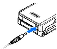
١. قم بتوصيل جهاز الشحن بمصدر التيار المتردد (المقبس).
