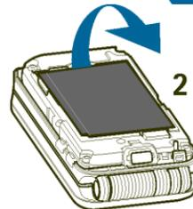
3. Para abrir el compartimento de la tarjeta SIM, tire con cuidado de la pestaña de bloqueo del compartimento de la tarjeta y ábralo (3). Introduzca la tarjeta SIM en su compartimento de forma que la zona de los contactos dorados se encuentre hacia abajo (4). Asegúrese de que la tarjeta SIM se ha insertado correctamente. Cierre la cubierta del compartimento de la tarjeta SIM (5) y presiónela con suavidad hasta que quede encajada en su sitio.
