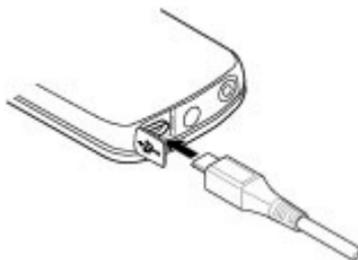
Abra a tampa do conector USB e ligue o cabo USB ao dispositivo.
