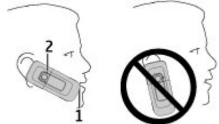
Geräuschunterdrückung zu erzielen, halten Sie das Gerät mit dem Hörer an Ihr Ohr und das Hauptmikrofon (1) an Ihren Mund. Verdecken Sie nicht das Mikrofon (2) auf der Rückseite des Geräts.
