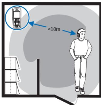
η απόδοσή τους. Η βέλτιστη απόσταση λειτουργίας υποδεικνύεται με σκούρο γκρι χρώμα στην εικόνα. Η σύνδεση υπόκειται σε παρεμβολές λόγω απόστασης και εμποδίων (υποδεικνύονται με ανοιχτό γκρι χρώμα) ή άλλων ηλεκτρονικών συσκευών.
