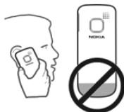
In der Abbildung ist der Bereich der GSM-Antenne grau markiert.
