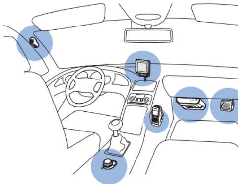
*Пример установки дисплея с использованием прилагаемой клейкой ленты.*
