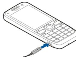
3. Wenn der Akku vollständig aufgeladen ist, trennen Sie das Ladegerät erst vom Gerät und dann von der Netzsteckdose.
