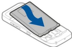
5. Pour remettre la façade arrière en place, placez d'abord les ergots de maintien supérieurs en face des encoches correspondantes, puis appuyez jusqu'à ce que la façade s'enclenche.
