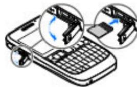
2. Inserire la memory card nell'alloggiamento, inserendo prima l'area dei contatti. Accertarsi che l'area dei contatti sia rivolta verso i connettori sul dispositivo.
