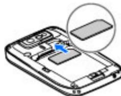
4. Inserire la batteria. Allineare i contatti della batteria con i connettori corrispondenti nell'alloggiamento della batteria, quindi inserirla seguendo la direzione della freccia.
