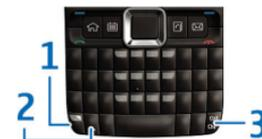
1 — Funktionstaste. Um die Ziffern und Zeichen einzufügen, die oben auf den Tasten abgebildet sind, halten Sie die Funktionstaste gedrückt und drücken dann auf die
