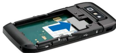
4. Setzen Sie den Akku ein. Richten Sie die Kontakte des Akkus mit den entsprechenden Anschlüssen im Akkufach aus und legen Sie den Akku in Pfeilrichtung ein.
