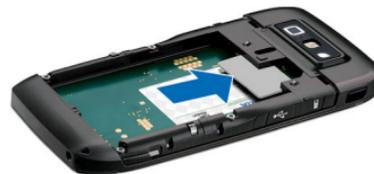
4. Inserire la batteria. Allineare i contatti della batteria con i connettori corrispondenti nell'alloggiamento della batteria, quindi inserirla seguendo la direzione della freccia.
