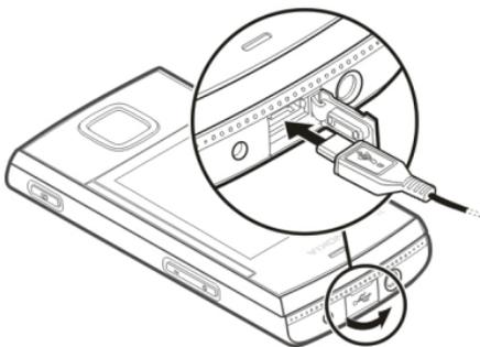
Abra a tampa do conector USB e ligue o cabo USB ao dispositivo.
