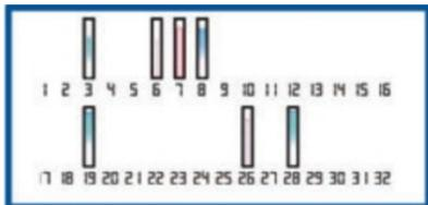
Si votre appareil a trouvé des satellites, chaque satellite est représenté par une barre dans la zone d'informations satellite. Plus la barre est longue, plus le signal satellite est puissant. Lorsque votre appareil a reçu suffisamment de données du signal satellite pour calculer votre position, la barre change de couleur.
