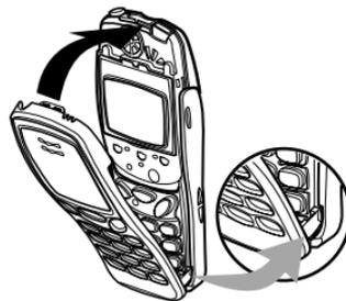
**Setzen Sie die Abdeckung der Rückseite wieder auf:** Setzen Sie die vier Riegel der rückseitigen Abdeckung in die entsprechenden Schlitze am Telefon ein, und drücken Sie die Abdeckung auf das Telefon, bis sie einrastet.
