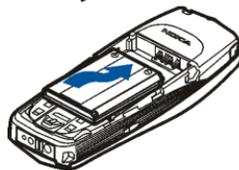
5. Montieren Sie die rückseitige Abdeckung des Telefons. Vergewissern Sie sich, dass die Sperren auf der Seite der Cover in die Kerben am Telefon einrasten.
