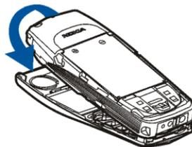
5. Pour replacer la façade arrière du téléphone, placez-la en face des taquets de verrouillage de la façade avant et faites-la glisser jusqu'à ce qu'elle s'enclenche. Voir [Installer la carte SIM et la batterie](#), page 17.
