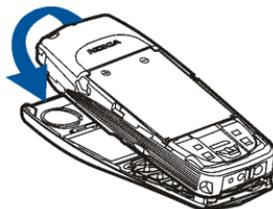
5. Per sostituire il cover posteriore, spingerlo verso i fermi sul cover anteriore e farlo scorrere fino a quando non scatta in posizione. Vedere [Inserimento della carta SIM e della batteria](#) a pagina 18.
