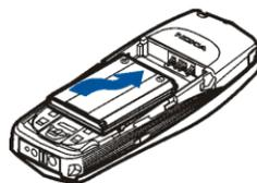
5. Reinstallare il cover posteriore. Accertarsi che i fermi di bloccaggio ai lati dei cover si trovino in corrispondenza degli incastri presenti sul telefono cellulare.
