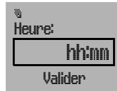
**Remarque :** le téléphone de voiture n'est pas équipé de sa propre batterie. De ce fait, le réglage de l'heure risque d'être perdu si la tension de la batterie du véhicule est faible.
