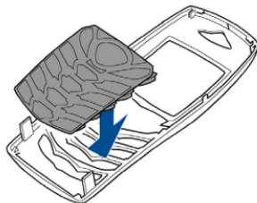
4. Pour replacer la façade avant, alignez-la avec le téléphone et appuyez doucement sur la base et le sommet du téléphone jusqu'à enclenchement.
