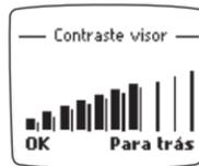
A barra de contraste existente no visor do telefone indica o contraste actual do visor.
