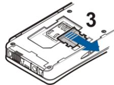
3. Legen Sie die SIM-Karte in das Telefon ein (4). Stellen Sie sicher, dass die SIM-Karte richtig eingelegt ist und die Seite mit den Goldkontakten nach unten zeigt.
