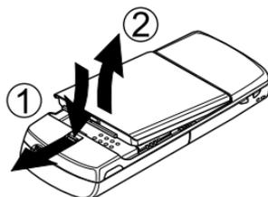
2 Abra la cubierta deslizante (1.) Inserte la tarjeta SIM (2.) asegurándose de que la esquina biselada está a la derecha y los conectores dorados hacia abajo. Siga las instrucciones que figuran en el teléfono.
