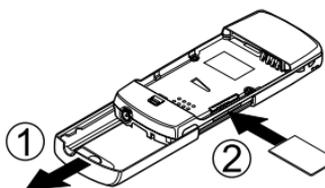
3 Cierre la cubierta deslizante, coloque el extremo superior de la batería (1) correctamente sobre el teléfono y bloquee la batería en la parte posterior del teléfono.(2).
