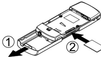
3 Fermez le volet coulissant et engagez convenablement l'extrémité supérieure de la batterie (1) sur le téléphone puis verrouillez la batterie à l'arrière de l'appareil (2).
