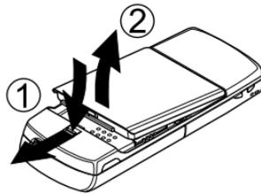
2 Ouvrez le volet coulissant (1). Insérez la carte SIM (2) en veillant à ce que le coin coupé soit à droite et que les contacts dorés soient en bas. Suivez les indications figurant sur le téléphone.
