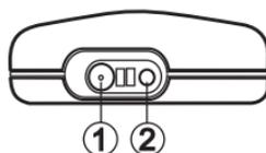
**NOTA:** El conector (2.) es el conector del ML portátil. No enchufe el ML portátil en el conector del cargador. Podría deteriorar el conector del cargador.
