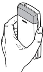
Evite tocar el área de la antena durante una llamada de teléfono, ya que así se optimiza el rendimiento de la antena y el tiempo de conversación del teléfono.
