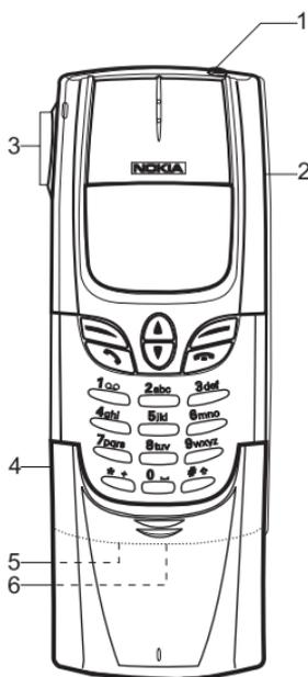
**1. Tecla de encendido.** El teléfono se enciende o se apaga al mantener pulsada la tecla **1** situada en la parte superior del teléfono.
