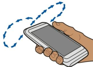
Kompas memiliki keakuratan terbatas. Bidang elektromagnetik, benda logam, atau kondisi eksternal lainnya juga dapat mempengaruhi keakuratan kompas. Kompas harus selalu dikalibrasi dengan benar.
