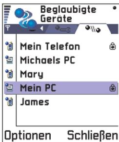
Abb. 4 Zwei Geräte werden als autorisiert gekennzeichnet.
