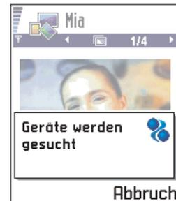
Abb. 3 Beim Senden eines Fotos über Bluetooth beginnt das Telefon, nach Geräten zu suchen.
