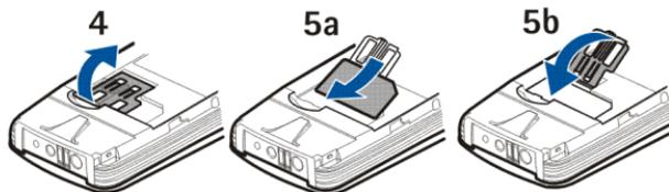
4. Haga coincidir los conectores dorados de la batería con los del teléfono y presione sobre el otro extremo de la batería hasta que quede encajada (6).
