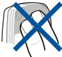
El teléfono tiene una antena incorporada. Al igual que ocurre con otros dispositivos de transmisión por radio, no toque la antena si no es necesario cuando el teléfono esté encendido. El contacto del cuerpo con la antena afecta a la calidad de la llamada y puede incrementar innecesariamente el nivel de potencia que necesita el teléfono para su funcionamiento. No tocar la antena durante una llamada optimiza el rendimiento de la antena y el tiempo de conversación del teléfono.
