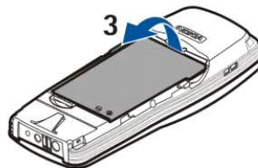
3. Levante el compartimento de la tarjeta SIM mediante la pestaña de extracción. Tire del compartimento para abrirlo (4). Inserte con
