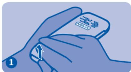
1 Schieben Sie einen Fingernagel in die Lücke, und heben Sie die rückseitige Abdeckung an.
