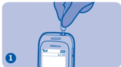
Schließen Sie ein Headset an. Das Headset-Kabel fungiert als Radioantenne.
