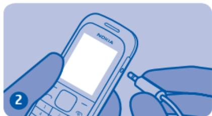
Schließen Sie das Ladegerät an das Mobiltelefon an.
