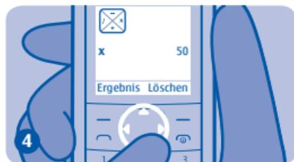
Um eine Funktion zu ändern, drücken Sie die Navigationstaste.
