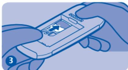
3 Achten Sie darauf, dass die SIM-Karte durch den Plastikbügel festgehalten wird.
