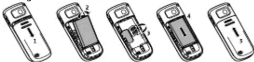
1. Um das rückseitige Cover abzunehmen, drücken Sie darauf und schieben es dann in Richtung Unterseite des Telefons vom Telefon herunter (1).
