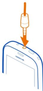
Nemojte spajati proizvode koji stvaraju izlazni signal jer to može uzrokovati oštećenje uređaja. Nemojte spajati naponske izvore na Nokia AV priključak. Ako na Nokia AV priključak spojite vanjski uređaj ili slušalicu koje nije odobrila tvrtka Nokia za upotrebu s ovim uređajem, posebnu pozornost obratite na razine glasnoće.
