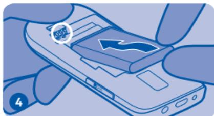
4 Alinee los contactos de la batería y, a continuación, empujela hacia dentro.
