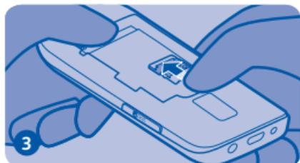
Deslice el compartimento de la tarjeta de memoria hacia la parte inferior del teléfono.
