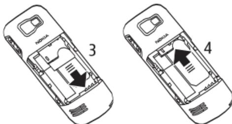
6. Виконайте кроки 3 і 4 розділу 'Встановлення SIM-картки та акумулятора', щоб встановити акумулятор і задню панель на місце.
