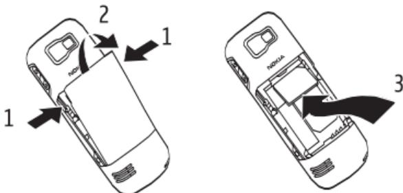
3. Вставте акумулятор у батарейний відсік (4). Переконайтесь, що контакти, що знаходяться у верхній частині акумулятора, збігаються з контактами на телефоні.
