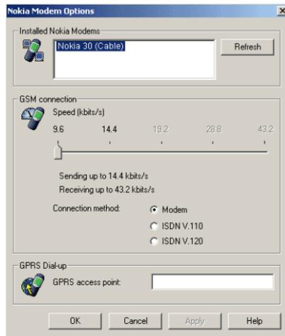
Se dispone di una connessione GPRS del fornitore di servizi Internet, è necessario specificare un punto di accesso GPRS per il modulo. È possibile ottenere tale punto di accesso dal fornitore di servizi Internet che fornisce inoltre la carta SIM utilizzata nel terminale Nokia 30.
