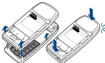
5. Τοποθετήστε το πίσω κάλυμμα στο τηλέφωνο (1) και σύρετε το πίσω κάλυμμα στη θέση του (2) μέχρι το κουμπί ασφαλευθέρωσης του πίσω καλύμματος να κλειδώσει.
