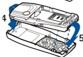
7. Placez la façade découpée dans la façade arrière en faisant glisser la première au-dessous des deux guides situés sur le milieu et sur la base de la façade arrière (6).
