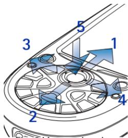
Fig. 3 Verwenden der Navigationstaste zum Navigieren.
