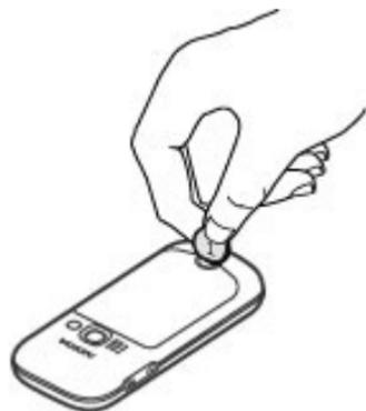
Um die rückseitige Abdeckung freizugeben bzw. auszutauschen, drehen Sie die Schraube mit einer Münze oder einem Schraubendreher.
