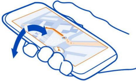
Der Kompass verfügt nur über eine begrenzte Genauigkeit. Elektromagnetische Felder, Metallgegenstände und andere äußere Umstände können die Genauigkeit des Kompasses weiter beeinflussen. Der Kompass muss stets ordnungsgemäß kalibriert sein.
