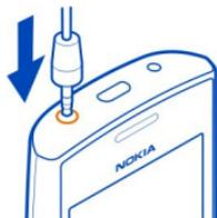
Schließen Sie keine Produkte an, die ein Ausgangssignal erzeugen, da das Gerät dadurch beschädigt werden kann. Schließen Sie keine Spannungsquelle an den Nokia AV-Anschluss an. Achten Sie besonders auf die Einstellung der Lautstärke, wenn Sie ein externes Gerät oder Headset, das nicht von Nokia für die Verwendung mit diesem Gerät zugelassen wurde, an den Nokia AV-Anschluss anschließen.
