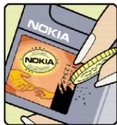
3. Raspe a margem da etiqueta para que seja revelado um código de 20 dígitos, por exemplo, 12345678919876543210. Vire a bateria de modo a que os números fiquem voltados para cima. O código de 20 dígitos lê-se começando pelo número da linha superior seguido pelo da linha inferior.
