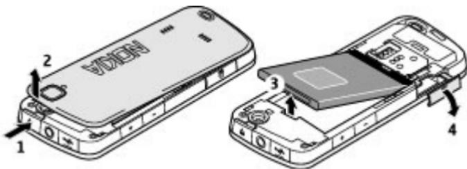
2. Abra la tapa de la tarjeta de memoria. Inserte la tarjeta SIM en el compartimento con la superficie de contacto mirando hacia abajo.
