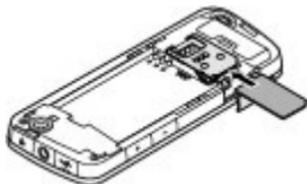
3. Observe os contactos da bateria e introduza-a. Feche a tampa do cartão de memória e volte a colocar a tampa posterior.
