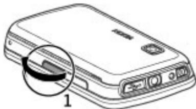
2. Inserire una memory card compatibile nell'apposito slot. Verificare che l'area di contatto sulla card sia rivolta verso l'alto. Spingere la memory card all'interno e bloccarla in sede.
