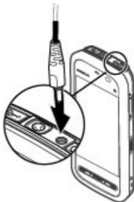
3. Quando il dispositivo indica che la batteria è completamente carica, scollegare il caricabatterie dal dispositivo, quindi dalla presa a muro.
